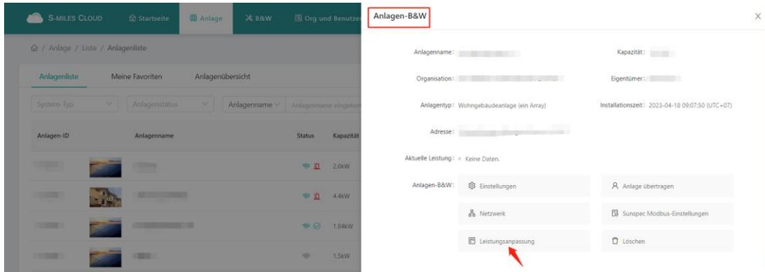
2. Geben Sie den gewünschten Grenzwert für die Ausgangsleistung ein, klicken Sie dann "Befehl erteilen" und warten Sie etwa 5 Minuten.
